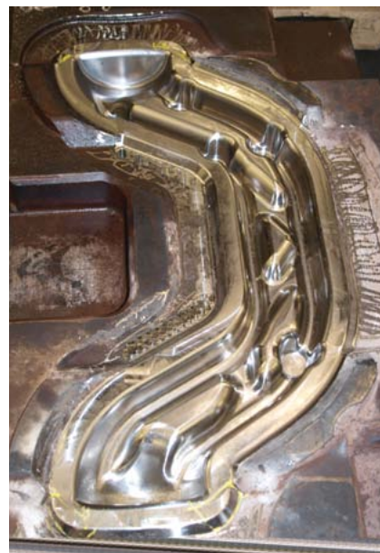
Vollverschweißtes Gesenk nach der Bearbeitung
