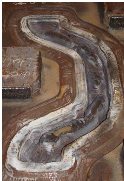
Vollverschweißtes Gesenk vor der Bearbeitung
